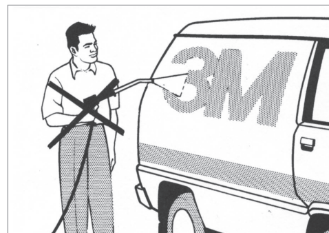
FALSCH: Der Wasserstrahl darf nicht flach auf die Folienkante gerichtet werden.
